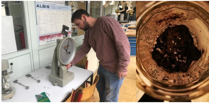
Abb.3: Schlagzähigkeitsprüfung und Test der biologischen Abbaubarkeit
